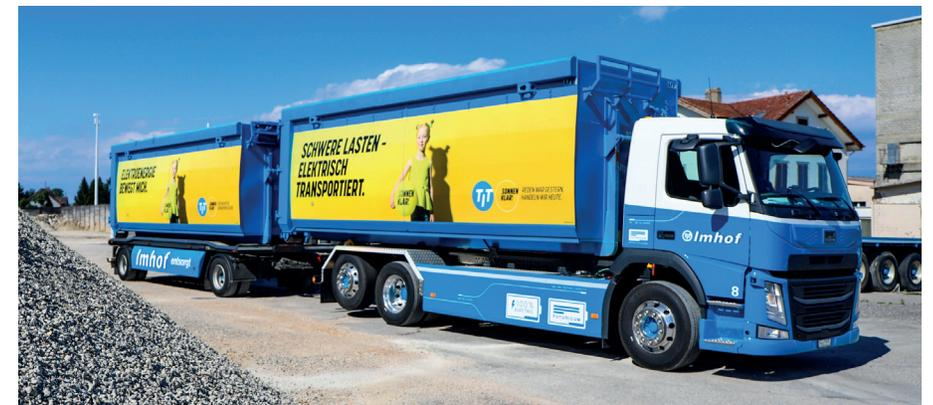
vollelektrischer Hakenabrollkipper mit einer Gesamtzugleistung von 40 Tonnen
